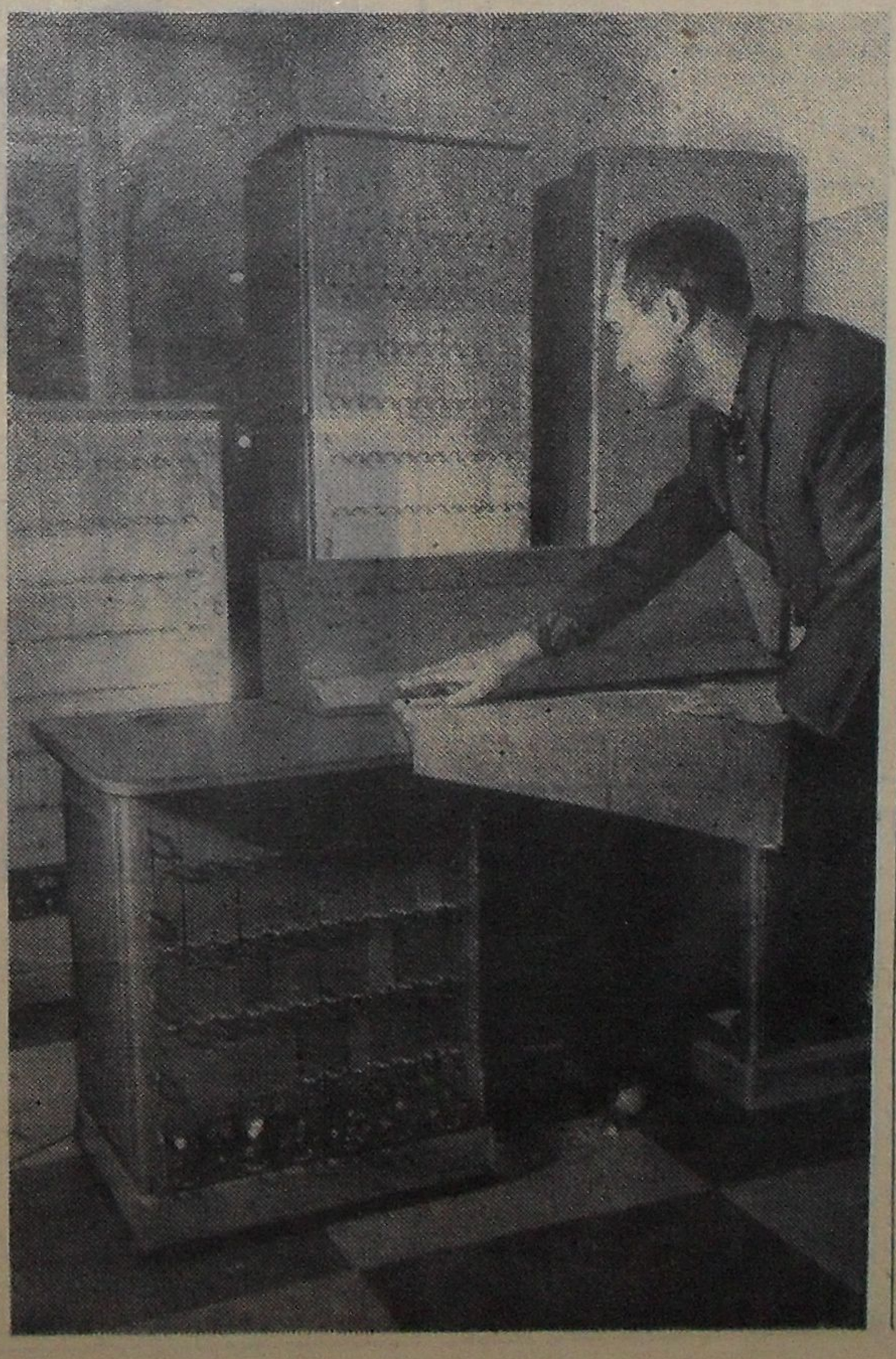
На снимке: старший инженер Лаборатории ядерных проблем А. А. Шуравин производит проверку разработанной им системы двухсторонней связи группы полуавтоматов для обработки снимков с пузырьковых камер на вычислительной машине «Минск-22».
