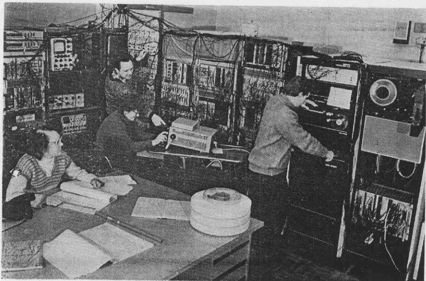
ЛАБОРАТОРИЯ ВЫСОКИХ ЭНЕРГИЙ. Установка СЯО [спектрометр ядер отдачи] готовится к эксперименту с поляризованным пучком дейтронов на синхротроне. Новое качество пучка ускорителя требует более совершенных аппаратных средств. Сотрудники сектора № 1 научно-экспериментального электронного отдела и сектора бесфилмовых камер будут использовать в этих исследованиях набор пропонациональных камер, сцинтилляционных и полупроводниковых детекторов. Модернизированная электроника включает линию для быстрой селекции и передачи данных из зала ускорителя в ЭВМ на пульте установки.
