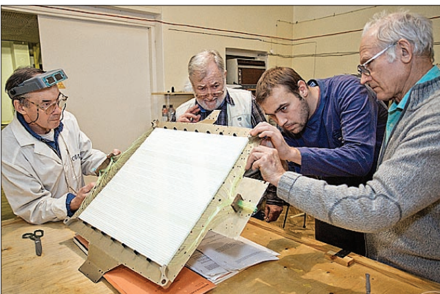
2011 год. Сотрудники ЛЯП ОИЯИ С. Ю. Пороховой, В. М. Гребенюк, А. А. Тимошенко и Л. Г. Ткачев за сборкой полетного образца триггерной системы НУКЛОН.
