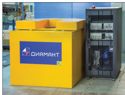
Анализатор горных пород, работающий по методу меченых нейтронов.
