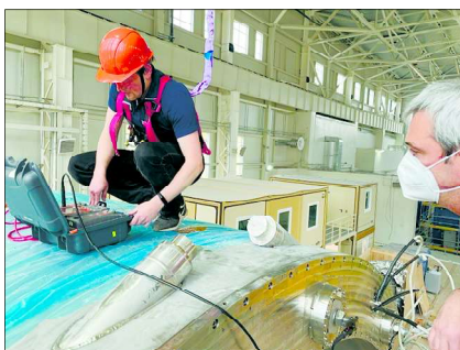
Проверка целостности сверхпроводящих кабелей обмотки соленоида.
