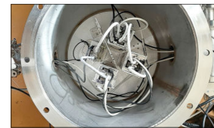
Установка для исследования редких мод деления. В центре камеры установлена делящаяся мишень, вокруг нее — четыре детектора Tiperix
