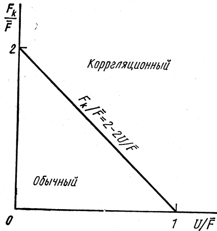
Рис. 4. Области применимости обычных и корреляционных методов.
