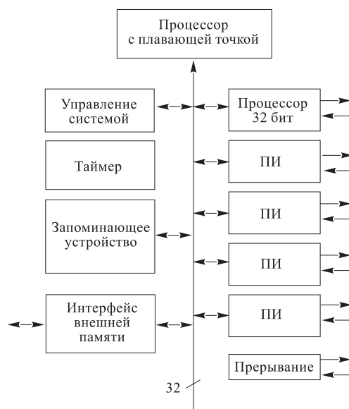
Рис. 22. Блок-схема типичного транспьютера. В одном кристалле содержится процессор с плавающей точкой и второй процессор с RISK-архитектурой, оперативную память. Наряду с каналом прямого доступа к памяти имеется четыре последовательных дуплексных канала обмена (ПИ — последовательный интерфейс)
