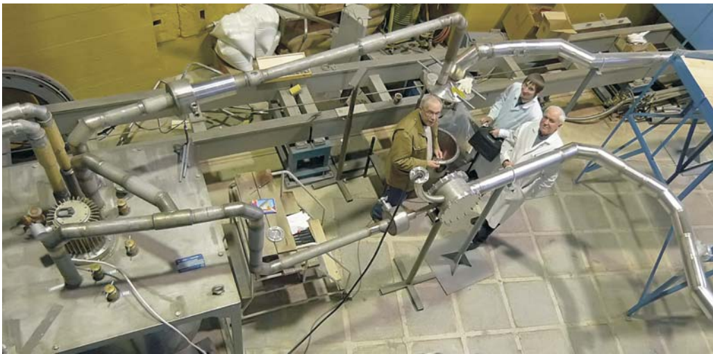
Лаборатория нейтронной физики им. И. М. Франка. Полномасштабный стенд для испытаний нового криогенного замедлителя реактора ИБР-2М
