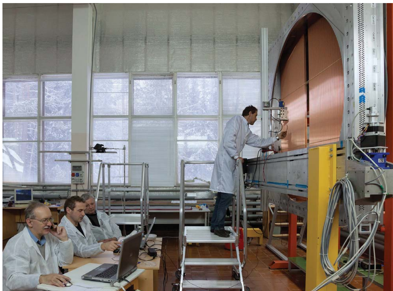
Лаборатория физики высоких энергий им. В. И. Векслера и А. М. Балдина. Работы по изготовлению полномасштабных модулей строу-детектора для эксперимента NA62
