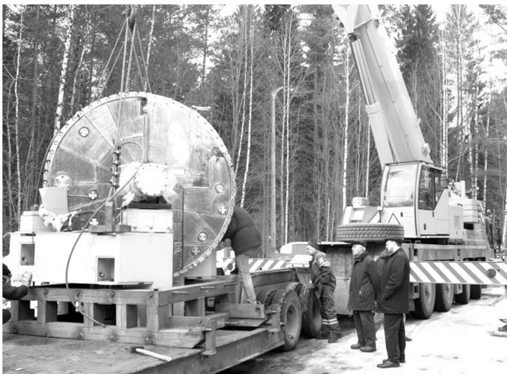
Лаборатория нейтронной физики им. И. М. Франка. Транспортировка нового подвижного отражателя ИБР-2 с испытательного стенда в здание реактора
