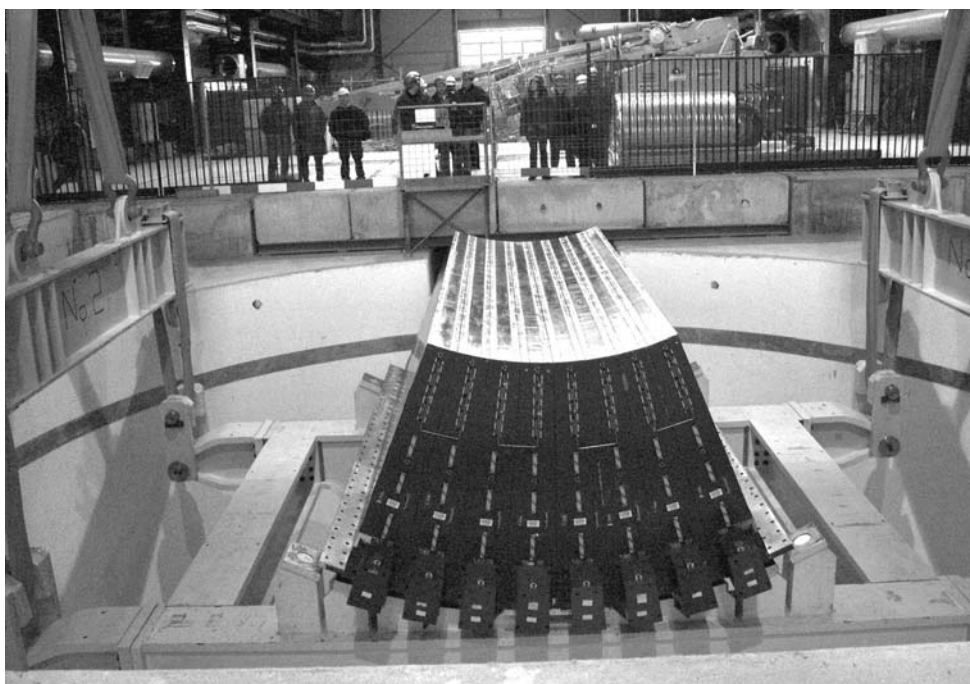
ЦЕРН, Женева. Восемь первых дубненских модулей, фрагмент адронного калориметра установки ATLAS, перед спуском в шахту ускорителя LHC
