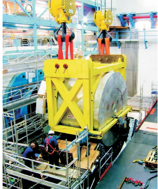
Рис. 1. Первая часть LAr end-сар-калориметра во время спуска в шахту на С-стороне
