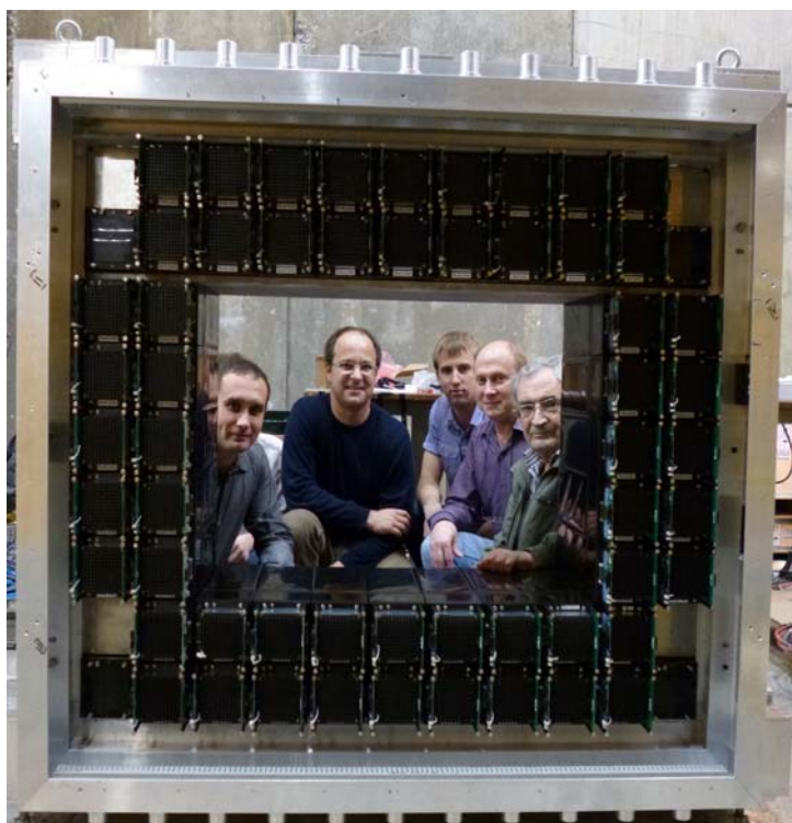
Группа сотрудников ОИЯИ во время сборки 56 ECAL0-модулей для испытаний DVCS
