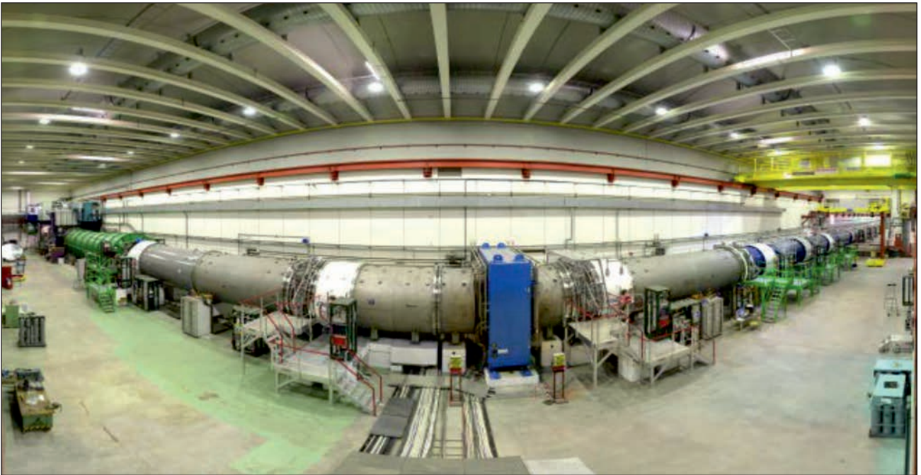
Рис. 1. Панорама экспериментальной установки NA62. В центре показан магнитный спектрометр на основе straw-трубок (серая область вакуумной емкости), спроектированный и построенный при определяющем вкладе ОИЯИ
