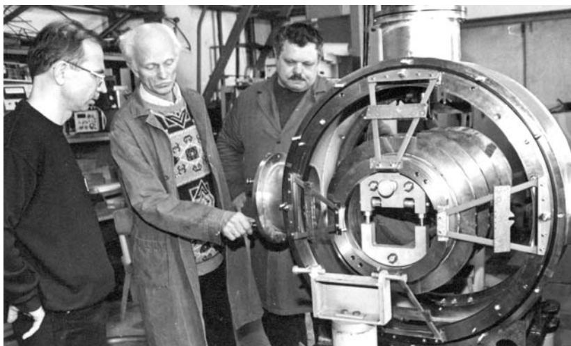
Лаборатория высоких энергий им. В. И. Векслера и А. М. Балдина. Новый сверхпроводящий источник ионов с электронно-циклотронным резонансом, разработанный для ускорителя ИЦ-10 ЛЯР им. Г. Н. Флерова
