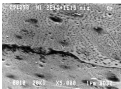
Рис. 3. Структура поверхности Ni, предварительно облученной ионами ^{86}\text{Kr} с энергией 305 МэВ до флюенса Ft = 2 \cdot 10^{15} \text{ см}^{-2} (верхняя часть изображения) и затем облученной ионами ^{86}\text{Kr} с энергией 245 МэВ до общего флюенса Ft = (2 \cdot 10^{15} + 1 \cdot 10^{15}) \text{ см}^{-2} (нижняя часть изображения)
