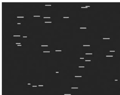
Рис. 17. Вертикальное сечение прямоугольного параллелепипеда ТСМ с топливными таблетками, случайно распределенными в его объеме
