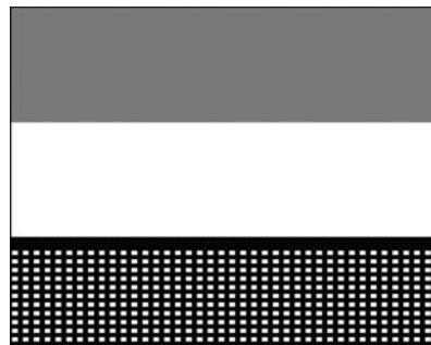
Рис. 18. Вертикальное сечение прямоугольного параллелепипеда ТСМ: трехслойная модель ТСМ, ограниченная слоем бетона снизу с нерасплавленным топливом в нижнем слое в виде кубической решетки таблеток
