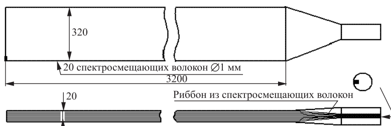
Рис. 4. Модернизированные сцинтилляционные счетчики CSP Wall и их размеры (в мм)
