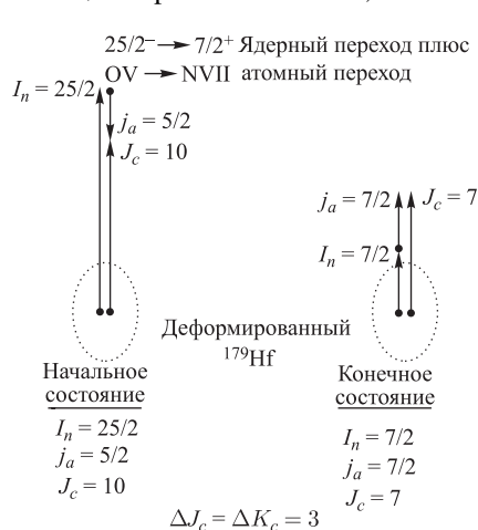
Рис. 15. Схема сложения векторов атомного и ядерного спинов до триггеринга (слева) и после (справа) для перехода в ^{179}\text{Hf} с m2 -уровня 25/2^- на уровень 7/2^+ [57]
