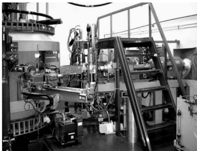
Рис. 44. Циклотрон CYCLONE30. Слева — магнит, по центру — линия транспортировки пучка
