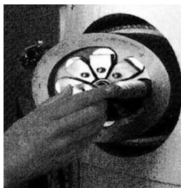
Рис. 28. Карусель для смены восьми мишеней расположена на внешней стороне магнита RDS111
