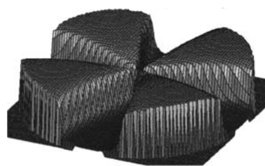
Рис. 20. Трехмерное изображение магнитного поля циклотрона RDS111. Глубокая вариация поля обеспечивает вертикальную фокусировку пучка
