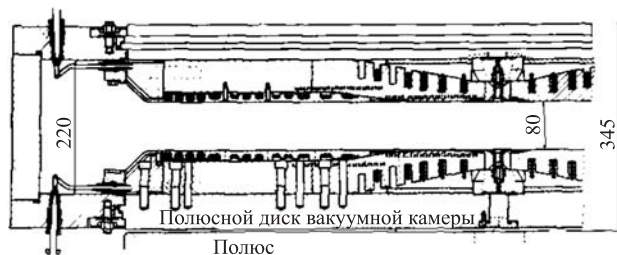
Рис. 15. Сечение спиральной шиммы У-120М. Показана развертка по осевой линии спирали
