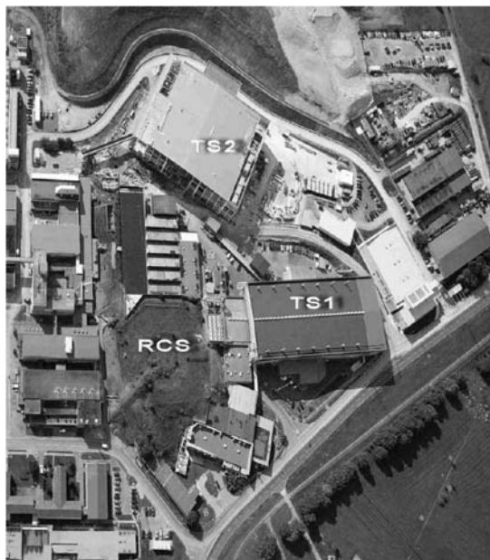
Рис. 40. Вид исследовательского центра ISIS в RAL. На рисунке отмечено расположение мишенных станций TS1 и TS2, а также протонного синхротрона на энергию 800 МэВ RCS [132]
