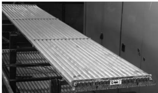
Рис. 37. Блок мюонной системы на стенде. Защитный кожух снят
