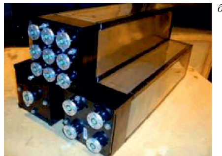
Рис. 32. а) Схема ECAL LHCb; б) три типа модулей ECAL LHCb в сборке
