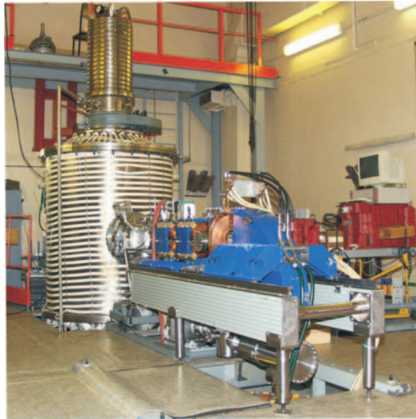
Рис. 6. Ускоритель-тандем с вакуумной изоляцией
