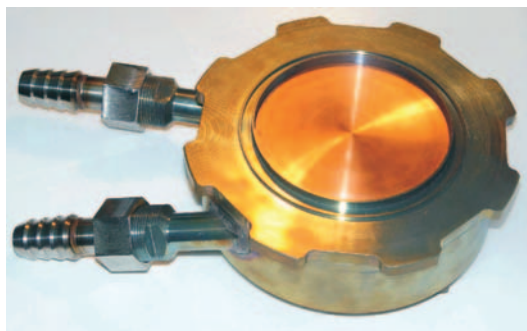
Рис. 19. Мишенный узел с приемником пучка
