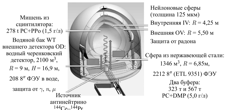
Рис. 1. Устройство детектора Vorexino и расположение источника ^{144}\text{Ce}-^{144}\text{Pr}
