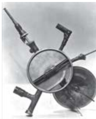
Рис. 1. Циклотрон, созданный в 1931 г. и считающийся первым работающим циклотроном в мире
