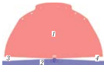
Рис. 12. Часть ускоряющей системы циклотрона, в которой используются один дуант (1) и противодуантная рамка (2). В этом случае имеются два ускоряющих зазора (3 и 4)
