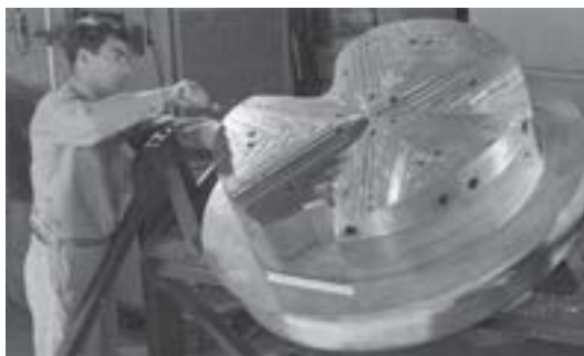
Рис. 29. Электронная модель первого циклотрона Томаса
