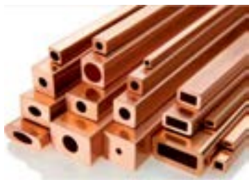
Рис. 19. Внешний вид полых медных проводников, используемых для изготовления токовых обмоток узлов ускорителей [37]
