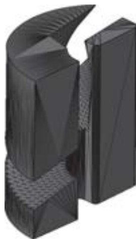
Рис. 74. Поверхность спирального инфлектора, представленная в виде \sim 4000 поверхностных треугольников
