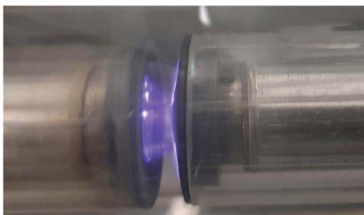
Рис. 4. Зона разрядного промежутка в среде дейтерия на образце палладия: а) «стабильный» разряд; б) «нестабильный» разряд; видны более интенсивно светящиеся пятна на образце палладия (слева), а также «лучи» с большей светимостью в разрядном промежутке и дискретными уплотнениями в нижнем плазменном «луче»
