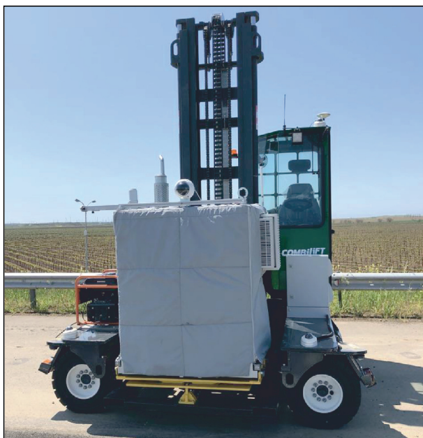
Рис. 42. Мобильный досмотровый комплекс ДНТ
