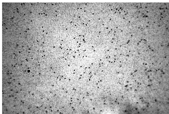
Рис. 3. Макрофотография при 20-кратном увеличении эмульсионной пленки, облученной в пучке ядер Хе, в области наибольшей плотности пучка
