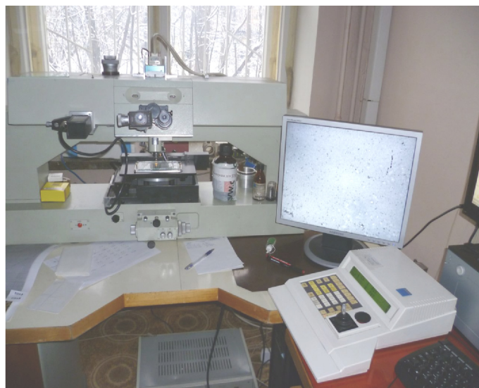
Рис. 8. Автоматизированный комплекс ПАВИКОМ-2 (ФИАН; создан на основе микроскопа МПЭ-11 с управляемым столиком, видеокамерой и платой захвата изображения); на экране — изображение участка облученной эмульсионной пленки
