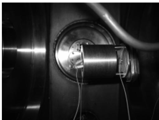
Рис. 5. Тестовая электронная пушка
