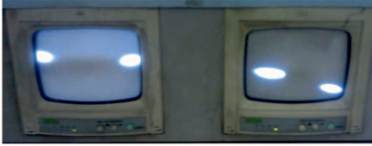
Рис. 12. Изображение встречных пучков на экранах СИ-мониторов: 1,1 мА электронного (слева) и 0,3 мА позитронного (справа). Амплитуда напряжения на пластинах ВЧ-разведения 6,5 кВ ( E = 1,85 ГэВ). Видны два положения двухоборотной орбиты
