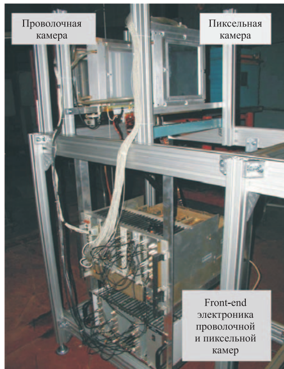
Рис. 11. Система из проволочной и пиксельной ионизационной камер, установленных на пучке выведенных ионов нуклотрона, в одном из сеансов
