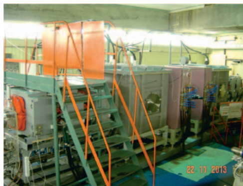
Рис. 2. Слева — электростатические deflectоры, конструкция которых позволяет менять расстояние между пластинами; справа — модернизированный сепаратор, готовый к проведению экспериментов
