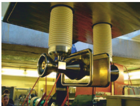
Рис. 2. Слева — электростатические deflectоры, конструкция которых позволяет менять расстояние между пластинами; справа — модернизированный сепаратор, готовый к проведению экспериментов
