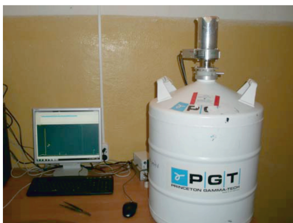
Рис. 3. Общий вид германиевого детектора
