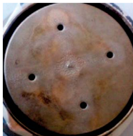
Рис. 3. Следы эрозии поверхности катода при симметрировании токоподводов по окружности фланцев
