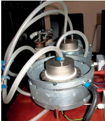
Рис. 4. Компоновка тиратронов с ферромагнитным экраном толщиной 9 мм в энергетической установке питания импульсного плазмотрона
