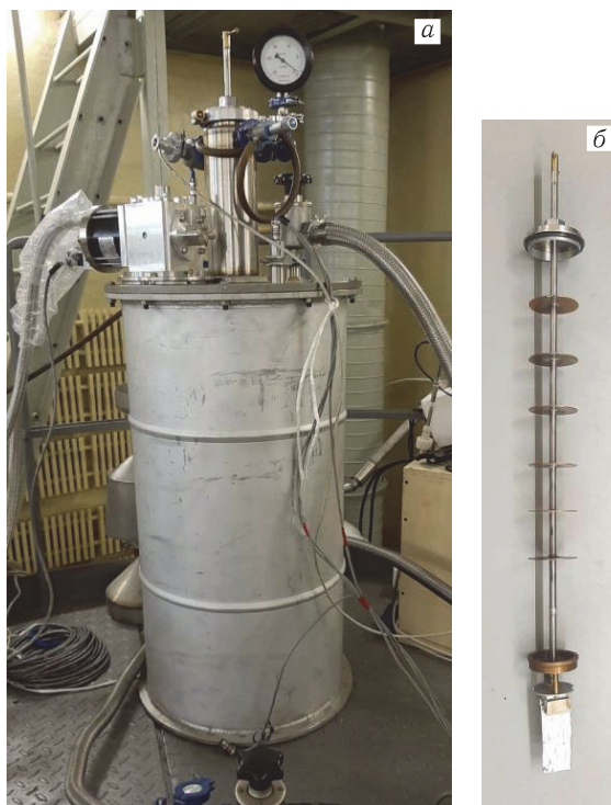
Рис. 2. Криостат (а), держатель с образцом (б)
