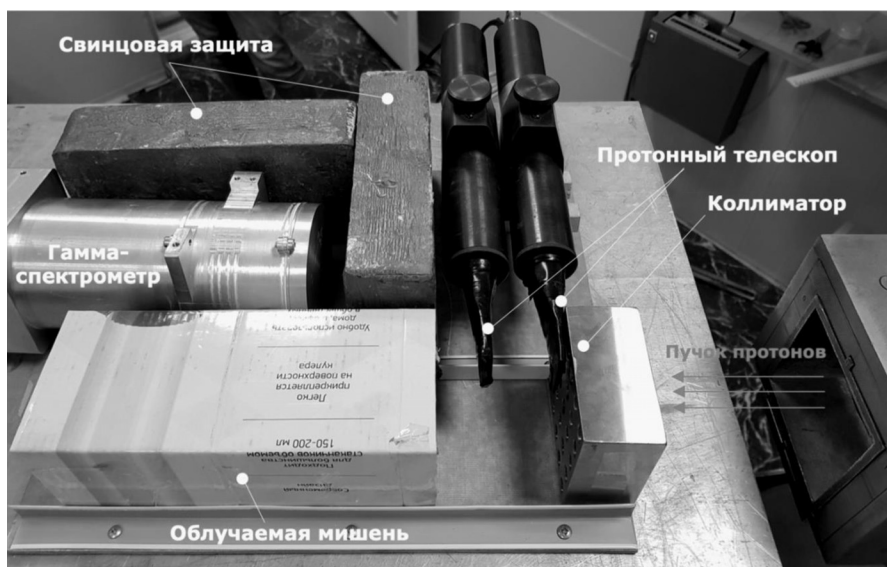
Рис. 2. Общий вид установки на пучке протонов медицинской кабины
