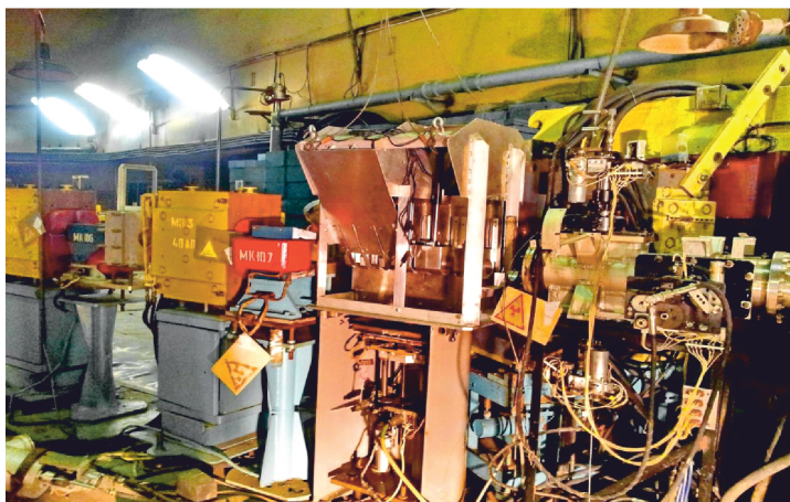
Рис. 3. Медный деградер при работе на тракте транспортировки P3
