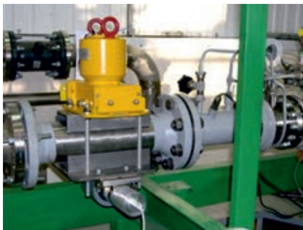
Рис. 1. Внешний вид макета спектрометрического гамма-плотнера во время испытаний на стенде многофазных потоков ГЭТ195-2011, ВНИИР (Казань)
