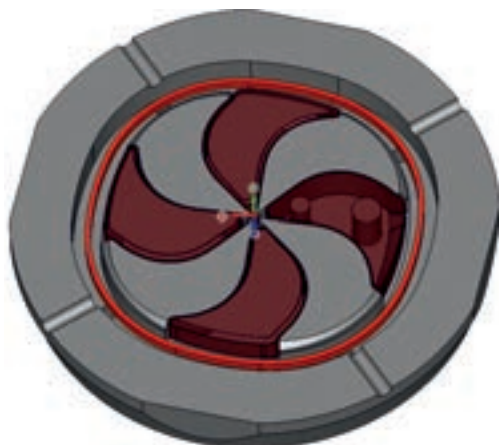
Рис. 1. Трехмерная компьютерная модель циклотрона (магнит и ускоряющая система)
