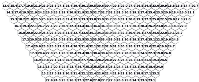
Рис. 12. Распределение энерговыделения по активной зоне (кВт/твэл) для 12-го варианта: UN + NpN (40 + 60 об. %) при обогащении 90% и 3-мм Gd-фильтре
