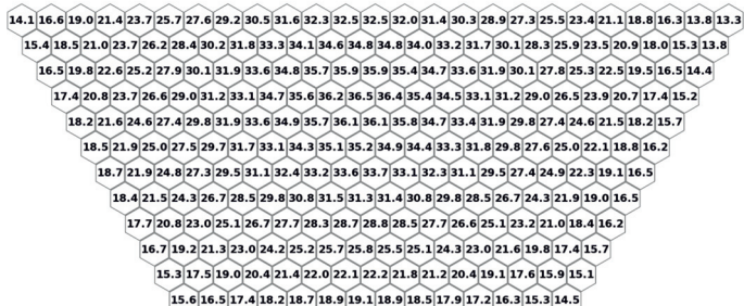
Рис. 11. Распределение энерговыделения по активной зоне (кВт/твэл) для 11-го варианта: UN + NpN (40 + 60 об. %) при обогащении 40% и 1-мм Gd-фильтре
