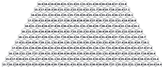
Рис. 7. Распределение энерговыделения по активной зоне (кВт/твэл) для справочного случая без дополнений
