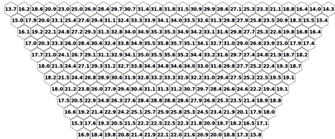
Рис. 8. Распределение энерговыделения по активной зоне (кВт/твэл) для 1-го варианта: PuN + NpN (10 + 90 об. %) при 1-мм Gd-фильтре
