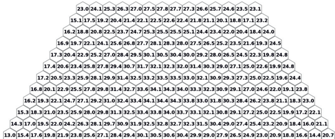
Рис. 11. Распределение энерговыделения по активной зоне (кВт/твэл) для 11-го варианта: UN + NpN (40 + 60 об. %) при обогащении 40% и 1-мм Gd-фильтре
