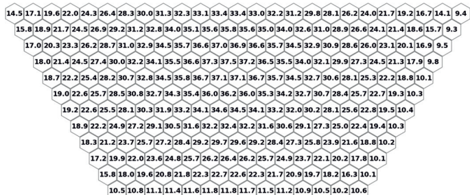
Рис. 10. Распределение энерговыделения по активной зоне (кВт/твэл) для 6-го варианта: PuN + ZrN (20 + 80 об. %) при 6-мм Gd-фильтре
