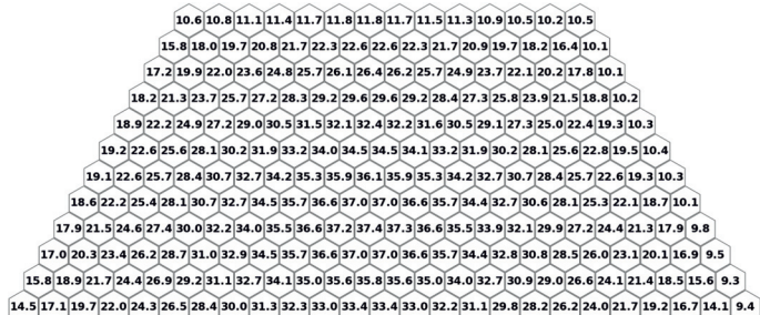
Рис. 9. Распределение энерговыделения по активной зоне (кВт/твэл) для 2-го варианта: PuN + NpN (15 + 85 об. %) при 1-мм Gd-фильтре
