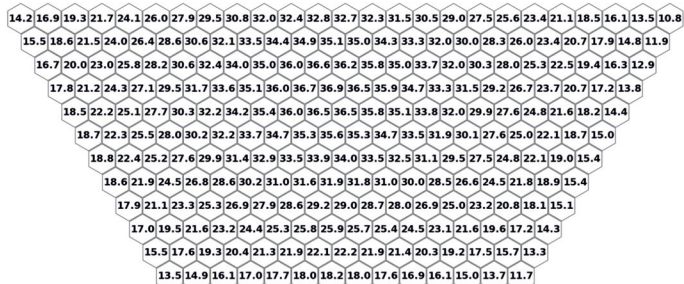
Рис. 7. Распределение энерговыделения по активной зоне (кВт/твэл) для справочного случая без дополнений
