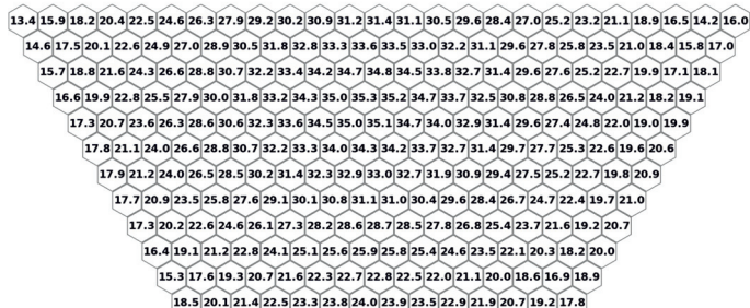
Рис. 9. Распределение энерговыделения по активной зоне (кВт/твэл) для 2-го варианта: PuN + NpN (15 + 85 об. %) при 1-мм Gd-фильтре
