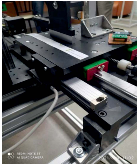
Рис. 5. Подвижные платформы для выставления положения головки относительно места сварки трубки
