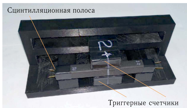
Рис. 5. Механическая часть с полосой органического сцинтиллятора и триггерными счетчиками
