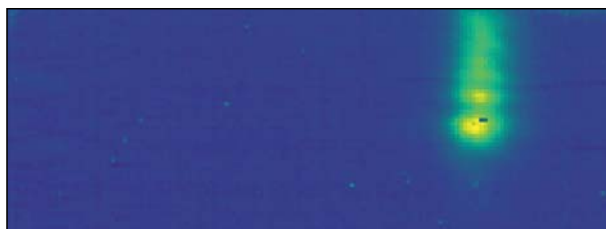
Рис. 10. Изображение спектра лазерного излучения на болометрической матрице
