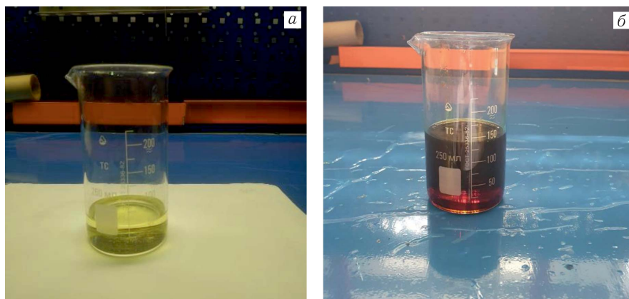
Рис. 7. «Легкая» (а) и «тяжелая» (б) фракции облученного мезитилена с поглощенной дозой 110 МГр после отогрева и откачки из прототипа камеры
