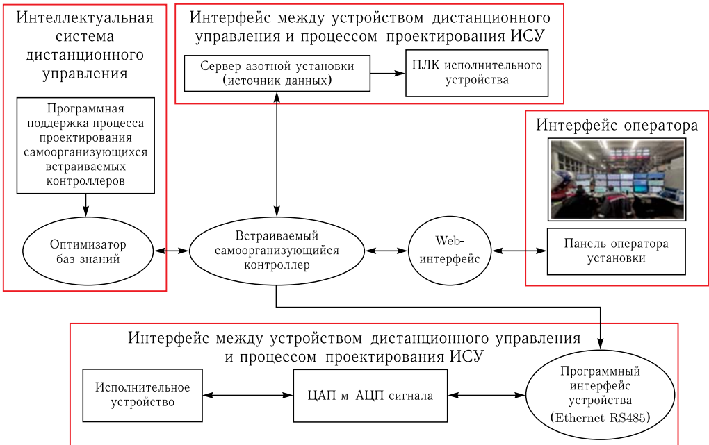
Рис. 1. Структурная схема системы связи и подсистем ИСУ с удаленным объектом управления
