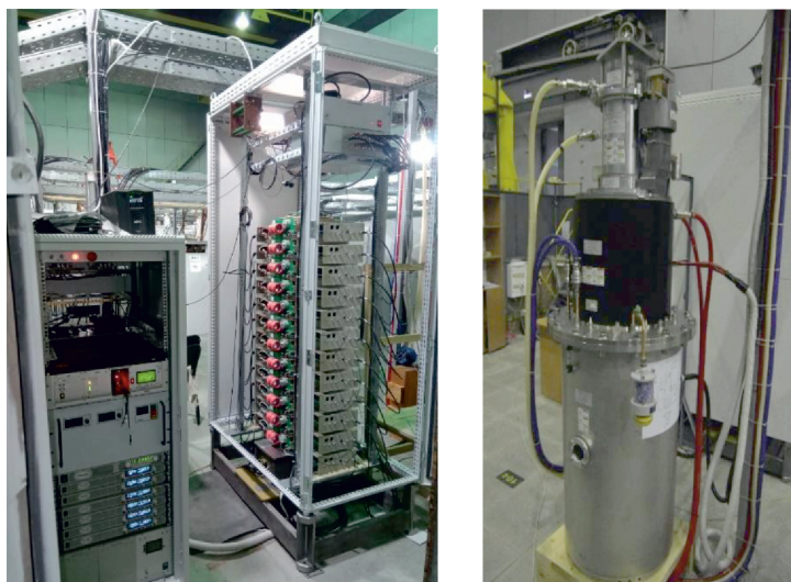
Рис. 3. Слева — стойка управления модулятором и модулятор; справа — клистрон Сапон Е3730А
