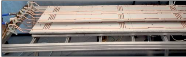
Рис. 4. Горизонтальное расположение контура системы охлаждения ECal с магистралями на стенде
