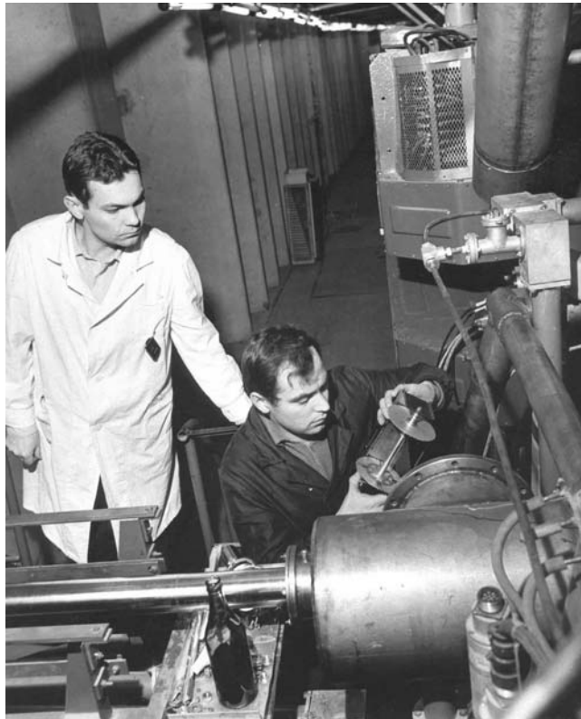
Фото 24. В. А. Никитин и А. А. Кукушкин возле устройства ввода внутренней мишени в ускорителе ИФВЭ
