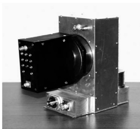
Рис. 2. Портативный нейтронный генератор ИНГ-27
