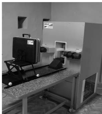
Рис. 1. Установка для идентификации скрытых веществ с помощью метода меченых нейтронов
